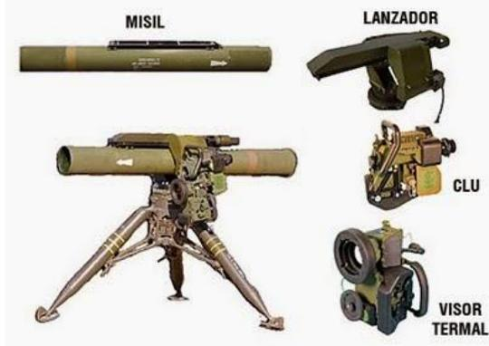
El proceso del disparo es guiado por infrarrojo electroóptico, a distancias entre los 200 m y los 8 Km. Está compuesto por varias piezas, el sistema de control, el lanzador con 4 misiles, el trípode y el Visor láserico. Misil apropiado para la infantería mecanizada, acorazada y motorizada.
