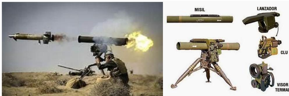
El proceso del disparo es guiado por infrarrojo electroóptico, a distancias entre los 200 m y los 8 kmt. Está compuesto por varias piezas, el sistema de control, el lanzador con 4 misiles, el trípode y el Visor láserico. Misil apropiado para la infantería mecanizada, acorazada y motorizada.
